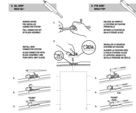
\* LA FIXATION POUR BRAS I&L ET PTB EST COMPATIBLE SEULEMENT AVEC LES BALAIS DE 17 po ET CEUX DE 19 po À 26 po.
