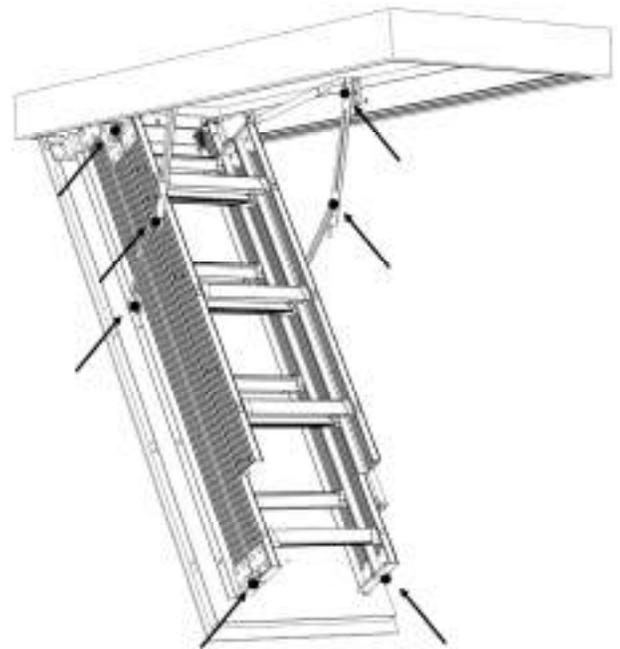
**FIGURE 33 : LUBRICATION POINTS**
