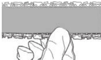
Vérifier la tension de la chaîne de la scie
