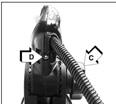
2. Tournez la vis d'ajustement (D) jusqu'à ce que le levier d'accélération ait un jeu de 4 à 6 mm (3/16 à 1/4 po).
