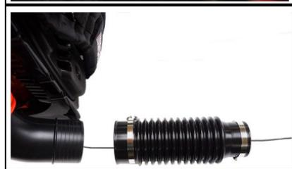
4. Monter le tube flexible (B) sur le coude (D) du souffleur. Placer l'anneau de guidage (G) à l'extérieur du tuyau flexible (loin du souffleur) et serrer le collier.
