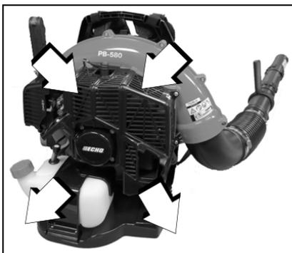
Le déblocage des passages d'air de refroidissement du carter moteur et le nettoyage des ailettes de refroidissement sont considérés être des «entretiens normaux». Aucune défaillance due à un manque d'entretien n'est couverte par la garantie.
