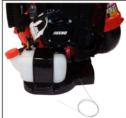
2. Cheminez le fil antistatique en dessous du boîtier du ventilateur et sécurisez le fils avec l'épingle du câble d'accélérateur (X). Mettre le fil à l'extérieur du coude de la soufflerie.
