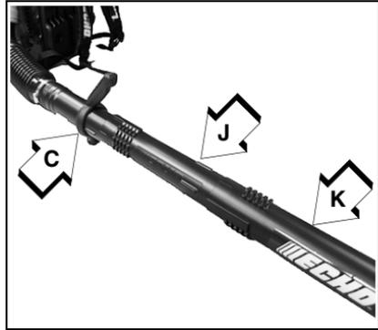
Remarque: Avec l'usage les raccords du tube se desserreront. Les systèmes de verrouillage exclusifs permettent de serrer les tubes. Si les tubes se desserrent, retirer les deux tubes droits et installer conformément aux instructions des étapes 7 et 8.
