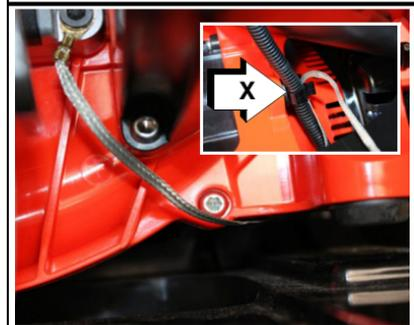
3. Insérez le fil antistatique au travers du tube flexible. Laisser suffisamment de leste au fil antistatique afin de permettre une pleine rotation du coude.
