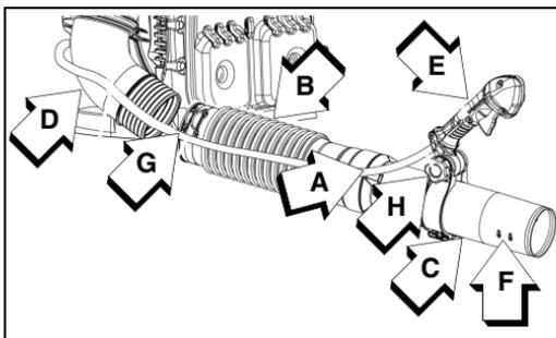
6. Insérez le fil antistatique au travers le tube articulé (fil se pendre librement dans le tuyau).
