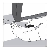
(12) Moulage de porte et plinthes : poser une planche (avec le côté décoratif vers le bas) à côté de la moulure de porte comme illustré dans la figure. Ensuite, faites glisser la planche sous le moulage.
