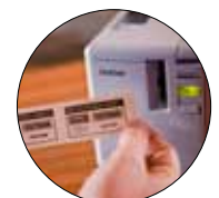
Impression de codes à barres et de numéros de série pour la gestion des actifs
