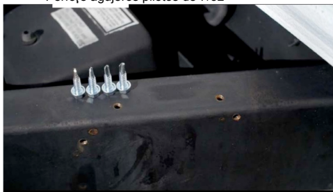
Fig. 4 - Se muestran los agujeros piloto con los tornillos autorroscantes incluidos.
