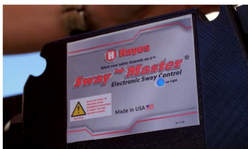
Fig. 8 -La luz de estado destellará 3 veces para indicar que se ha activado la unidad.
