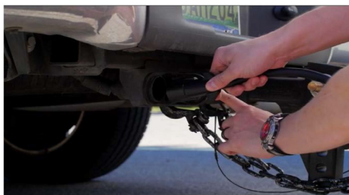
Fig. 7- Insérez la fiche Sway Master MC dans la douille à 7 voies. Insérez la fiche à 7 voies de la remorque dans la douille Sway Master MC .
