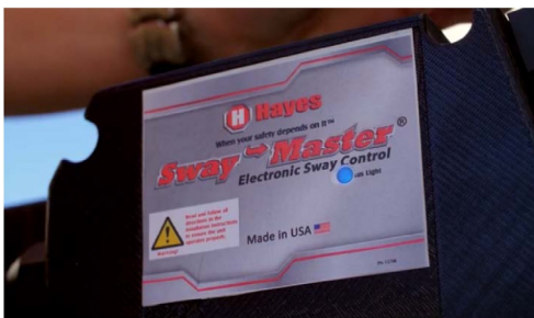
Fig. 8 -Le voyant d'état clignote 3 fois pour indiquer que l'unité est activée.
