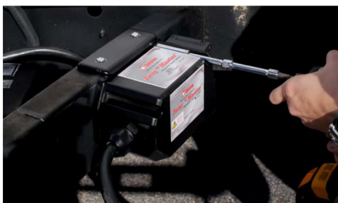
Fig.5 – À l'aide d'une douille de 3/8 po, fixez l'unité Sway Master MC à la remorque avec les vis à tôle fournies.
