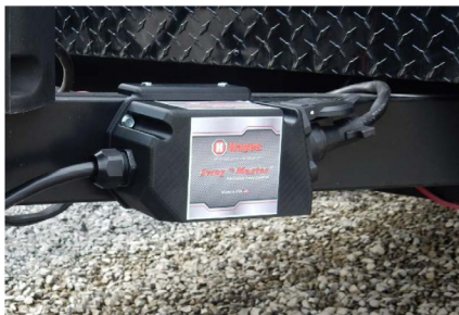
Fig. 1 - Se muestra la posición de montaje correcta. La parte superior del Sway Master™ debe tener una vista despejada del cielo.
