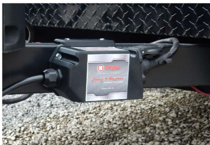
Fig. 1 - Position de montage représentée. La partie supérieure de Sway Master MC doit avoir une vue dégagée du ciel.
